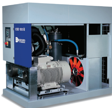
Sidopaneler enkla att demontera, underlättar vid service- och underhåll.
